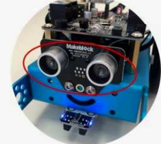
Capteur Ultrasons : capte la distance de l'obstacle.
