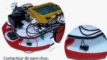
Contacteur de pare-choc, détecte si le pare-choc est enfoncé ou relâché
