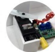
Le **Servomoteur**, ici branché sur le boîtier Gromy, est un système motorisé qui converti l'énergie électrique en une rotation, dont l'angle est choisi précisément et qui peut le maintenir.
