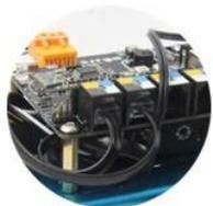
Interface sur une **carte programmable** de type « Arduino » ou compatibles. Les capteurs et les actionneurs sont câblés directement sur la carte qui sert aussi d'interface.
