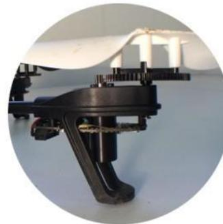
Le **moteur électrique** permet de faire tourner les pales du **drone**. Le moteur va convertir l'électricité en énergie mécanique correspondant à la rotation de l'axe du moteur. (...) et entrainer les engrenages des pales. L'action mécanique des pâles (poussée) sur l'air permet au drone de s'élever.
