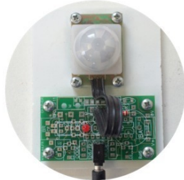
Capteur infrarouge : détection des personnes
