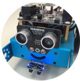
Capteur Ultrason : détection d'obstacle
