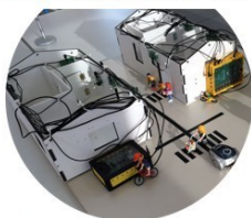
Les câbles permettent de transmettre le signal des capteurs à l'interface programmable (ici, des boîtiers Picaxes).
