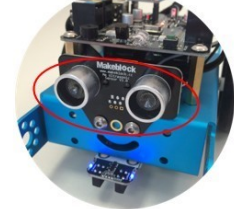
Capteur Ultrasons : capte la distance de l'obstacle.
