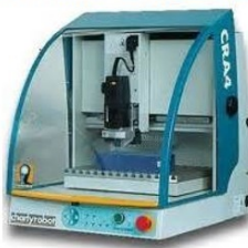
Par enlèvement de matière par fraiseuse avec le Charlyrobot.
