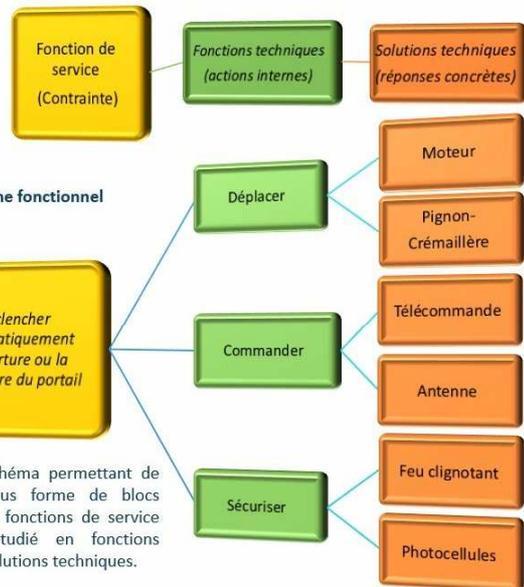
La représentation fonctionnelle est utilisée pour décrire et expliquer le fonctionnement d'un objet technique. Elle a pour objectif de mettre en évidence les relations entre les fonctions techniques et les solutions techniques par rapport aux fonctions de services du cahier des charges.
